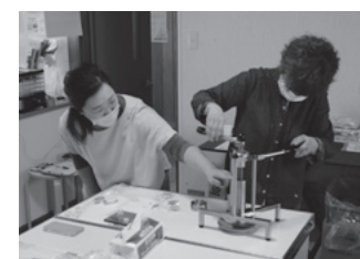
⑥種をひとつひとつ種わり機で割り、専用のしぼり機に入れしぼり出すときれいな黄金の椿油を取ることができる
