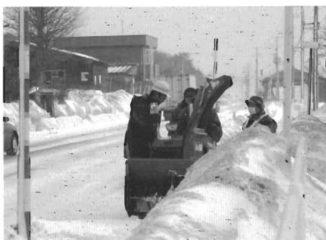
▲作業中は機械に近づかないように!
