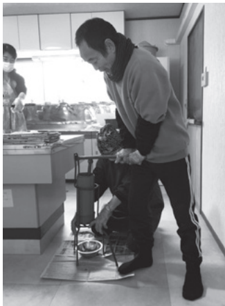
▲ お手製の搾り機では、蒸した種をガーゼにくるみ、力を入れてつぶしていきます
