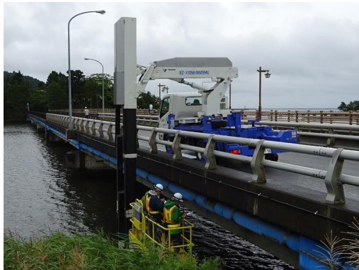
写真 4-1 従来の点検方法（橋梁点検車）
